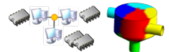
Разбиение расчётной области между ядрами для высокопроизводительных вычислений
